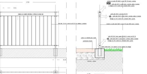
Particolare di un modulo relativo al parapetto dell'attraversamento della roggia su via Pola
