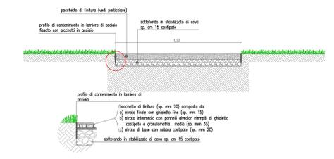
Particolare della pavimentazione del percorso pedonale con grigliato di contenimento e ghiaietto
