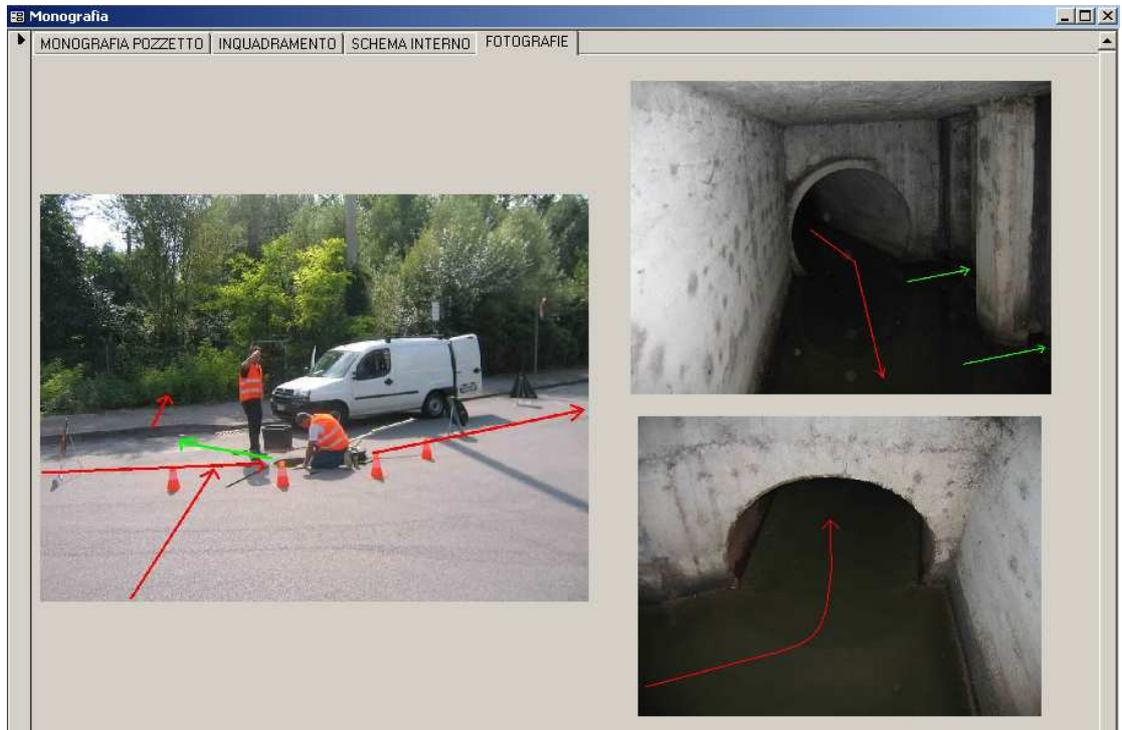
Figura 4: schema fotografico del posizionamento dei collettori e dello stato delle camerette
