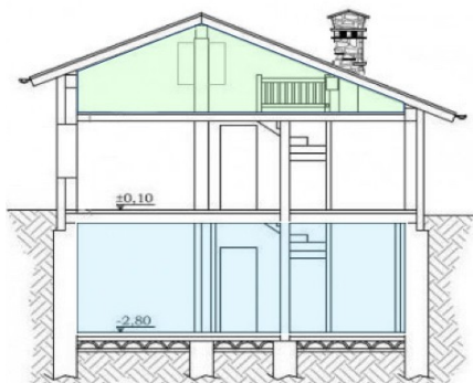
Edificio con sottotetto e piano interrato
