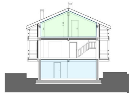
Edificio con sottotetto e piano seminterrato
