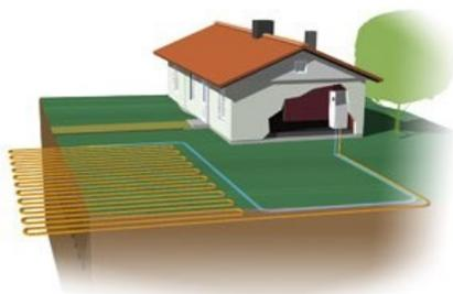
*Pompa di calore geotermica orizzontale: rappresentazione grafica*
