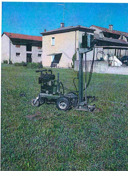
Prova penetrometrica dinamica media P2
