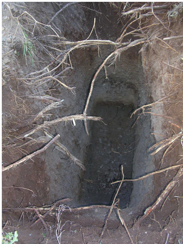
Foto 1: Sezione trincea esplorativa T1
