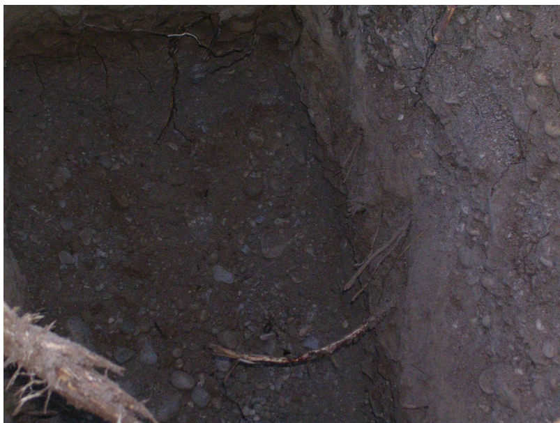
Foto 2: Particolare livello limo-argilloso con sabbie fini trincea esplorativa T1
